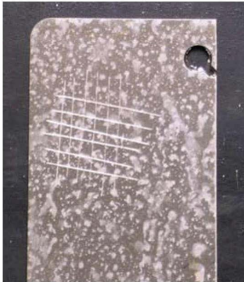
VpCI-429で洗浄後、VpCI-386クリヤーを塗装した。
