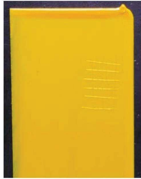
VpCI-429で洗浄後、VpCI-386 イエローで塗装した
