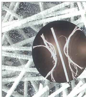
MCIを添加したポリプロピレンモノフィラメントファイバー。新設コンクリートの収縮ひび割れを減少。
