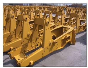
VpCI®-391は、スプレー、ブラシ、ロール、またはディッ プで塗布できる一液の水溶性で、除去可能なコーティング です。乾燥後、目立たない薄い透明なフィルムになります が、塗装されていない表面と塗装された表面の両方を保護 します。溶接前の表面を保護し、アルカリ洗浄剤で簡単に 除去できます。
