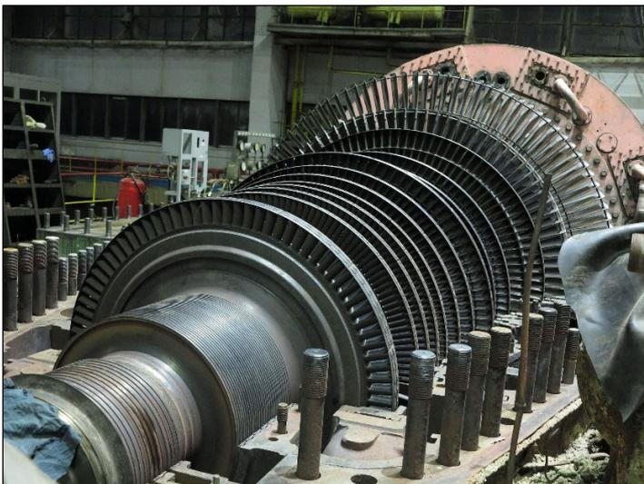
ElectriCorr™ は、電気および電子機器だけに仕様されているわけではありません。2016年には、蒸気タービンローターの除錆後のフラッシュ錆防止に使用されました。製造メーカーの推奨要領でさえ、沿岸発電所の高塩化物と高い湿気環境では、作業員が補修したタービンを元に戻す前に再錆化を防ぐことは出来ませんでした。しかし、全てのローター表面にエレクトリコア VpCI®-239 を使用することで、最終的に問題は解決されました。
