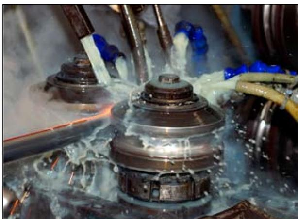
M-250 は推奨添加量により、金属加工中のフラッシュ錆を防ぎ、加工後の工場内保管時の防錆を可能とします。さらに、それは加工時の泡立ちを引き起こさず、加工液の寿命を延ばします。
